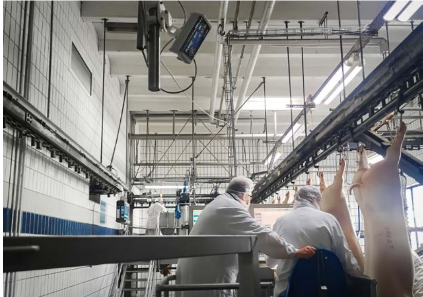
KI-unterstützte Klassifizierung: Die „Classifai“-Box unterstützt die Mitarbeiter bei der Begutachtung von Tierwohlmerkmalen bei Schweine-Schlachtkörpern.
